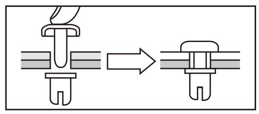
(誤) リベットの頭部側と脚部側を分けて、挟み込んで差し 込んだ状態。差し込んだだけなので抜けてしまいます。
